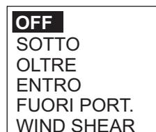
[OLTRE]: viene emesso l'allarme quando la temperatura dell'acqua è superiore al valore impostato.
