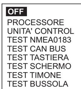
5. Ruotare la manopola **Course control** per selezionare l'elemento da verificare, quindi premere la manopola per avviare il test.
